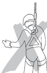
Es dürfen nur Geräte, die mit Haken mit Sicherheitsbügeln ausgerüstet sind, in die Zugöse gehängt werden. Dabei ist darauf zu achten, dass der Haken nicht zu groß dimensioniert ist. Die Öse muss mittig im Hakengrund liegen und der Haken muss in der Öse frei beweglich sein.
