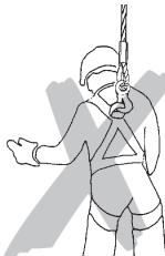
Seuls les appareils munis de crochets équipés de lingues de sécurité peuvent être accrochés à l'oeillet de la traverse. S'assurer que le crochet n'est pas trop large. L'oeillet doit être centré au niveau du fond du crochet, et le crochet doit pouvoir s'articuler librement dans l'oeillet. Un seul câble ou une seule tige ne peuvent être saisis simultanément.
