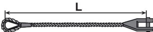
Elingue câble à 1 brin équipée d'une douille à chape à une extrémité.
