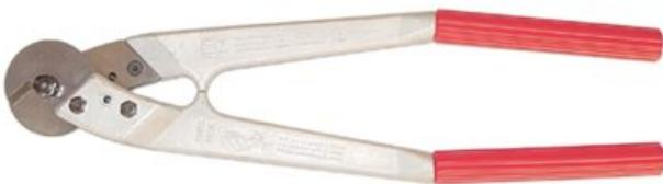
Permet de couper des fils d'acier, de cuivre et d'aluminium, les câbles électriques et les câbles multibrins. Les bords coupants sont conçus pour former une prise sur le câble, en forme de triangle lors de la coupe, ce qui empêche le détoronnage de l'extrémité du câble.
