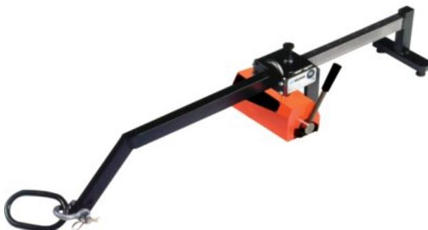
Le bras de levage NEO HV, combiné à l'aimant de levage NEO est une aide polyvalente pour déplacer des charges de l'horizontal à la verticale et inversement. Par exemple, si une plaque est sur une palette et que vous devez la déplacer sur une tour, vous devez normalement utiliser des chaînes, des pinces et au moins deux personnes. Avec un bras de levage équipé de l'aimant de levage permanent NEO, vous économiserez de la main-d'œuvre et rendrez l'opération plus efficace.
