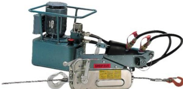
L'équipement TIRFOR® hydraulique se compose d'un groupe hydraulique qui permet de manoeuvrer à distance (ensemble ou séparément) 1, 2 ou 4 appareils TIRFOR® TU-16H/1600kg ou TU-32H/3200kg, munis de vérins hydraulique auto-inverseurs.
